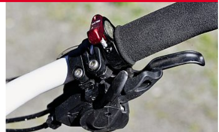
Mit der Shimano-Schaltzentrale kommen auch SRAM-Fahrer auf Antrieb klar. Tadellose Hinterbaukinematik, 14 cm Federweg.
