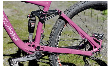
Mit der Shimano-Schaltzentrale kommen auch SRAM-Fahrer auf Antrieb klar. Tadellose Hinterbaukinematik, 14 cm Federweg.
